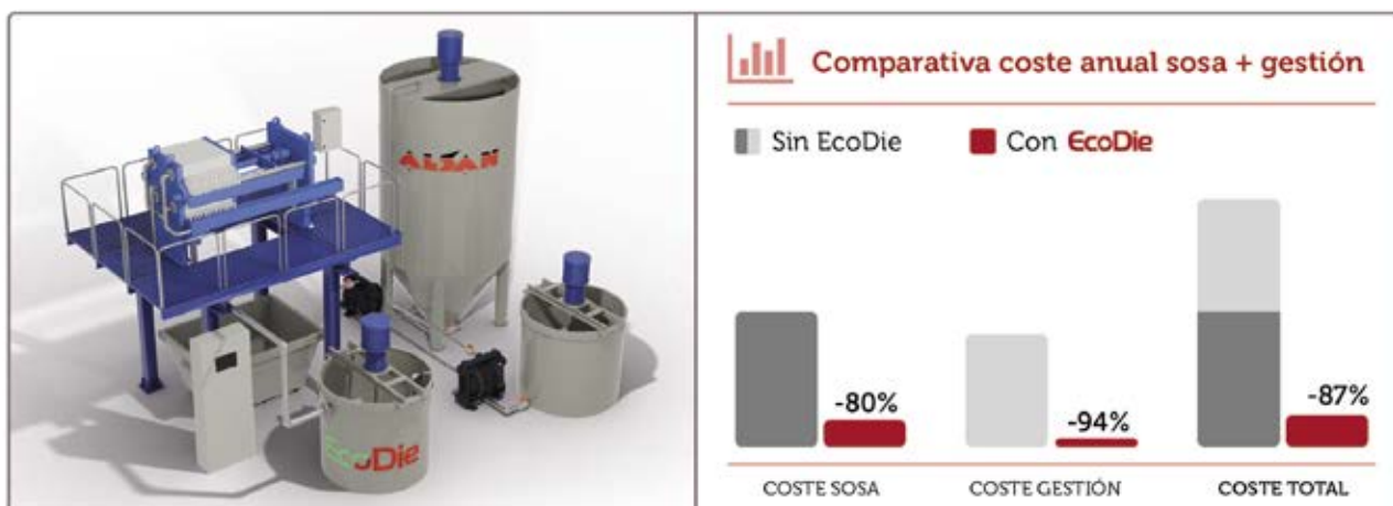
La figura 3. Muestra una representación tridimensional del sistema EcoDie junto con el ahorro económico que supondrá en términos de materias primas (soda cáustica) y gestión de residuos.
